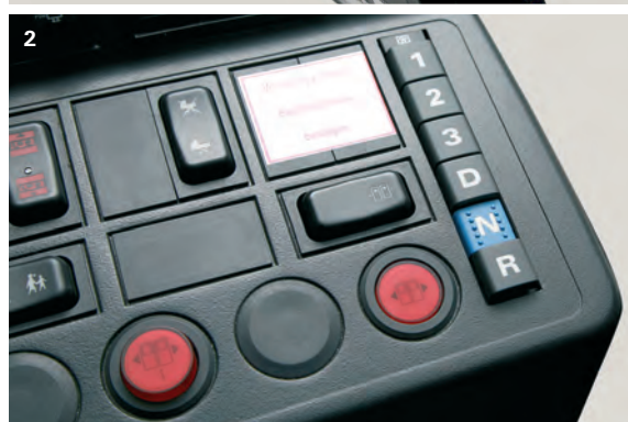
1/2 selector de marchas versión como selector con 3 o 6 botones, vertical o horizontal
